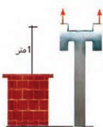
شکل ۱ - ۶۲: نصب صحیح لوله دودکش داخل اتاق
